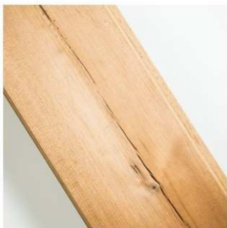
Malé praskliny na povrchu jsou povoleny
