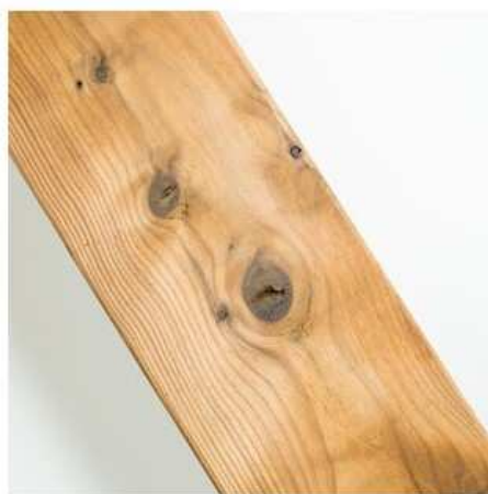
Praskliny v sucích jsou povoleny
