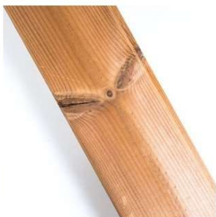
Praskliny v sucích jsou povoleny
