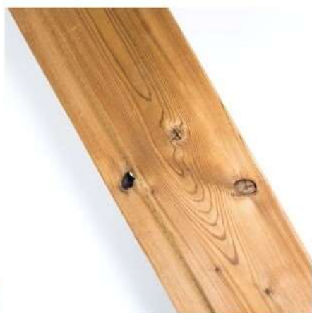
Malé otvory po vypadlých sucích, ojedinělý výskyt je povolen
